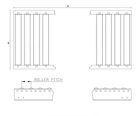
ROLLER SITS ABOVE CHANNEL STEEL ROLLER 50MM DIAMETER NYLON ROLLER 48MM DIAMETER
